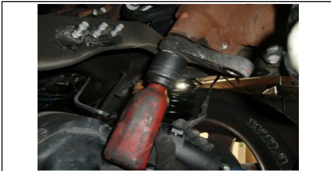
31. Remove the pitman arm nut.
