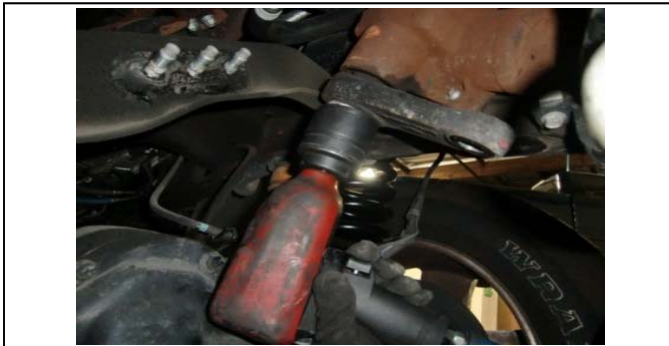
31. Remove the pitman arm nut.
