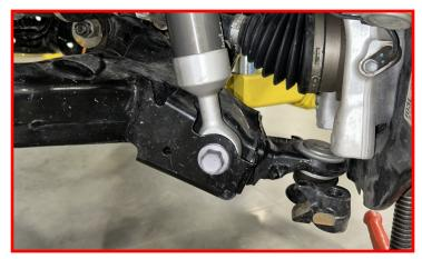
Install the factory sway bar bolt.
