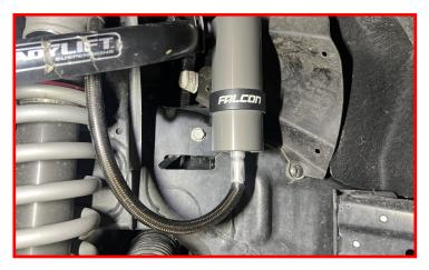
Install the factory sway bar bolt.
