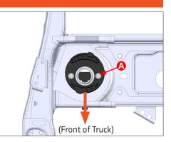
MAKE SURE THE UPPER BRACKET HOLE IS ORIENTED TOWARDS THE FRONT OF THE TRUCK.
